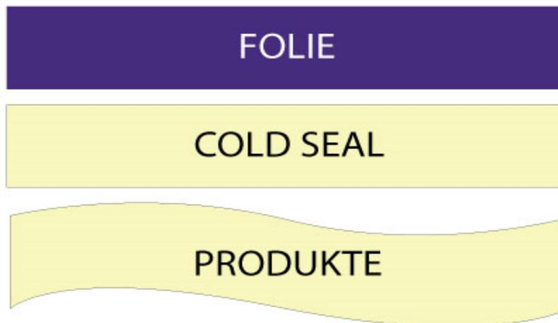
Antiblockierlack schützt gegen das Ankleben von Siegeln dank die Anwendung von Kaltsiegel Kleber auf der Rückseite (Hauptsächlich auf Basis von Polyamidharzen).
